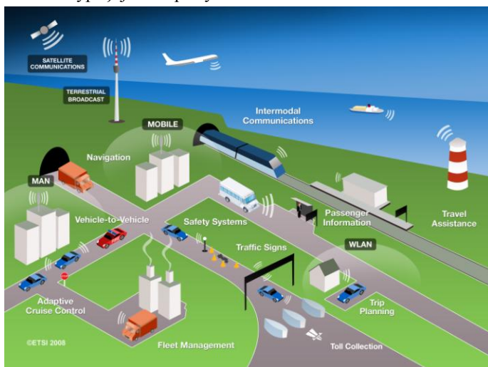
Слика 3. Интелигентни транспортни системи укључују телематике и све типове комуникација у возилима, између возила (возило-возило) и између возила и фиксних локација (возило-инфраструктура). Међутим, није ограничен само на друмску комуникацију већ може користити информационо комуникационе технологије и других инфраструктурних система
